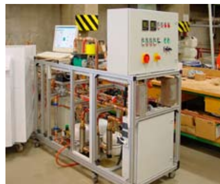
HiL-Prüfstand für ein vorheriges Projekt mit Wärmepumpen (Quelle: FH Düsseldorf, Fachbereich Maschinenbau und Verfahrenstechnik, Arbeitsgruppe E 3 )
